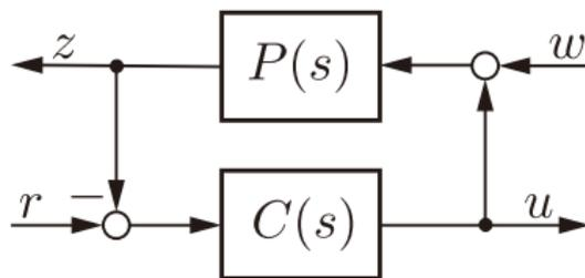
**安定性の定義** (フィードバック制御系の有界入力有界出力安定性)
