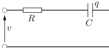
Fig. 4.4: RC 回路
